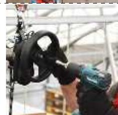
Nota: Utilice siempre la velocidad más baja del destornillador a baterías (máx. 350 rpm); torque mínimo sugerido 20N.m
