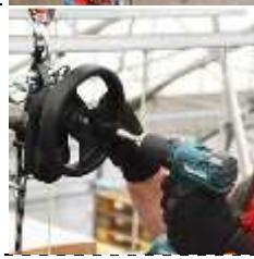
Remarque : Utilisez systématiquement le tournevis affichant un engrenage faible (maximum 350 tr/min) ; couple minimum conseillé : 20 N.m
