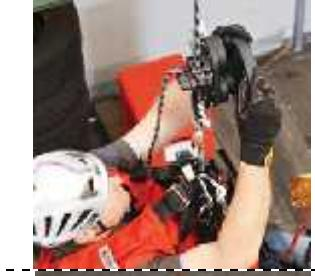
6/ Spasitelj se želi spustiti na tlo. Oslobađa dugi kraj užeta iz stezaljke užeta i provodi ga iznad gornje lijeve uške. Srušta se zajedno s unesrećenim.
