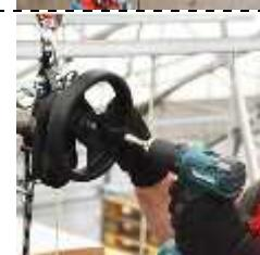
Hinweis: Verwenden Sie immer die langsamste Geschwindigkeit des Akku-Schraubers (max. 350 rpm); empfohlenes Mindestdrehmoment 20N.m
