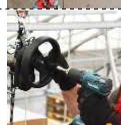
Nota: Utilizzare sempre la velocità più bassa del cacciavite a batteria (massima 350 giri al minuto). Si suggerisce una coppia pari a 20 N.m.
