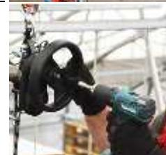
Uwaga: Zawsze należy używać najniższego biegu wkrętarki akumulatorowej (maks. 350 obr./min.). Zalecany moment obrotowy to 20Nm
