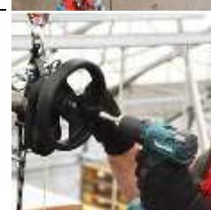
Opmerking: Gebruik altijd de laagste versnelling op de schroevendraaier (max. 350 rpm); aanbevolen minimale koppel 20N.m
